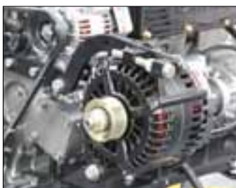
12 volt 50 amp and 140 amp alternators
