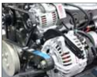
12 volt 50 amp and 140 amp alternators
