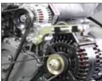
12 volt 50 amp and 240 amp alternators
