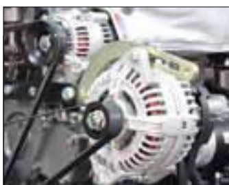
12 volt 50 amp and 140 amp alternators
