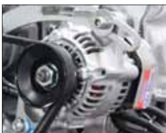
12 volt 50 amp alternator
