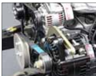
12 volt 50 amp and 240 amp alternators
